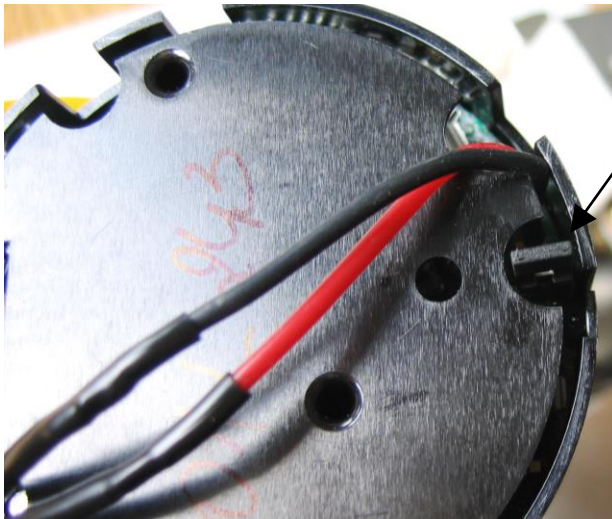
Rys.5. Widok zwory układu podświetlenia wskaźnika w podzespołe elektroniki dla przetworników ciśnienia w wykonaniu MID
